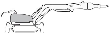
У башни неограниченный угол поворота, обеспечивающий возможность работы в нескольких направлениях, не передвигая машину. На машине установлены поворотные тормоза. Когда отсутствует необходимость в повороте, поворотный механизм блокируется пассивными тормозами.
