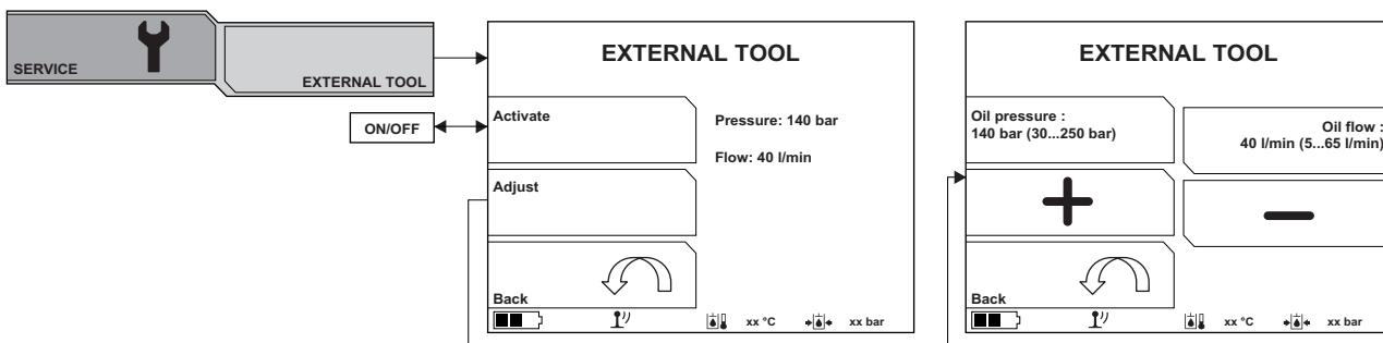
Машина может использоваться в качестве источника питания для дополнительных гидравлических инструментов.
