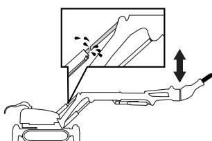
Цилиндр 3 выдвинут, молот работает вниз. Нельзя допускать работу машины, если цилиндры находятся в крайних положениях.
