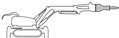
На машину устанавливают навесное оборудование, которое предназначено для выполнения тех или иных задач. Вес и эксплуатационные параметры навесного оборудования являются решающим фактором для принятия решения о пригодности оборудования для машины. Более подробную информацию см. в главах "Навесное оборудование" и "Технические данные" инструкций изготовителя.
