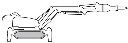
Каждая гусеница приводится во вращение с помощью отдельного гидромотора. Поворот машины осуществляется благодаря разным скоростям вращения гусениц. При вращении гусениц в разные стороны машина разворачивается на месте. Когда приводы гусеницы отключены, приводные двигатели блокируются пассивными тормозами.
