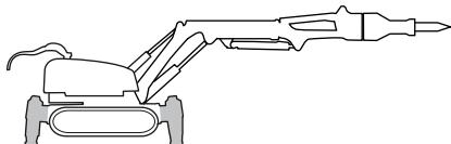
Опоры предназначены для того, чтобы машина была устойчивой. Во время работы машины следует в обязательном порядке выдвигать опоры.
