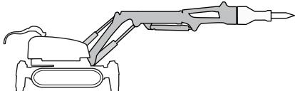
Манипулятор состоит из трех конструктивных элементов, благодаря чему достигается большой радиус рабочей зоны и компактность при необходимости. Выдвижение штоков снижает вероятность появления люфта в шарнирах.
