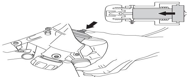
Смажьте втулку направляющего ролика густой смазкой. Наложите смазочный шприц на ниппели (A) и накачивайте густую смазку, пока из переливного отверстия не будет выходить чистая смазка (B).
