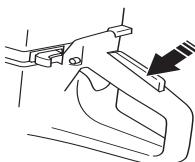
Проверьте, чтобы пускатель и фиксатор пускателя ходили легко и чтобы их пружинная возвратная система функционировала.
