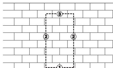
**ВНИМАНИЕ!** Если выполнить в начале верхний горизонтальный разрез, а потом нижний горизонтальный, то заготовка упадет на лезвие и зажмет его.
