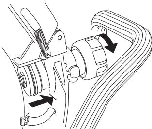
Направляющий ролик вдавлен в ролик. Чтобы освободить направляющий ролик на ручке, поверните ручку еще, пока она не освободится полностью.
