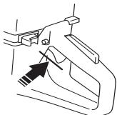
Прижмите внутрь фиксатор пускателя и проверьте, чтобы он возвратился в свое исходное положение когда он будет отпущен.
