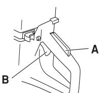
При отпускании ручки, пускатель и фиксатор пускателя возвращаются в свои исходные положения. Это осуществляется при помощи двух
