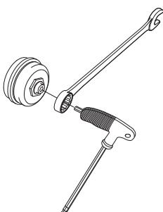
Перед установкой новых роликов, смажьте ролики внутри густой смазкой для подшипников.
