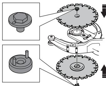
**CHÚ Ý!** Đừng quên siết đai và kiểm tra điều chỉnh đai trước khi cắt. Xem chỉ dẫn dưới tiêu đề "Kiểm tra và điều chỉnh đai truyền động".
