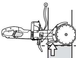
**警告！**在任何情况下，都必须避免使用锯片的侧面来切割；否则锯片很可能损坏、破裂，进而导致巨大的损坏。只可使用切割部分。
