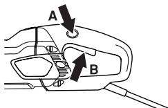
電源スイッチが押されている間、電源スイッチロックは押されたままになります。ハンドルのグリップが解放されると、電源スイッチと電源スイッチロックの両方がリセットされます。この動作は、2つの独立したリターンスプリングが制御しています。この位置で、本機が停止し、電源スイッチがロックされます。
