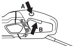
只要按下电源开关，电源开关锁便会保持按下状态。松开把手后，电源开关和电源开关锁均会复位。这一动作由两个独立的回位弹簧控制。该位置会使机器停止且电源开关被锁定。
