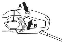
Фіксатор перемикача живлення залишається натиснутим, доки натиснуто перемикач живлення. При попусканні захвату рукоятки і перемикач живлення, і фіксатор цього перемикача повертається в початкове положення. Цей рух контролюється двома незалежними зворотними пружинами. Це положення веде до зупинки інструмента та блокування перемикача живлення.
