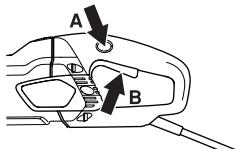
Güç anahtarına basıldığı müddetçe güç anahtarı kilidi basılı kalır. Tutamak üzerindeki kavrama bırakıldığında, güç anahtarı ve güç anahtarı kilidi sıfırlanır. Bu hareket, iki bağımsız dönüştürücü yay tarafından kontrol edilir. Bu konum, makinenin durmasına ve güç anahtarının kilitlenmesine neden olur.
