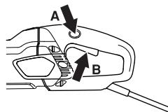
Dispozitivul de blocare a comutatorului de pornire rămâne apăsat atât timp cât comutatorul de pornire este apăsat. Atunci când se eliberează clema de pe mâner, atât comutatorul de pornire, cât și dispozitivul de blocare a comutatorului de pornire sunt resetate. Această mișcare este controlată de două arcuri de rapel independente. Această poziție duce la oprirea aparatului și la blocarea comutatorului de pornire.
