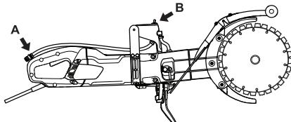
Захисний роз'єднувач при замиканні на землю
