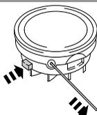
Não prima o botão mais do que três vezes. Se tiver linha em excesso, o cortador da linha fica obstruído e o aparador funcionará mal.
