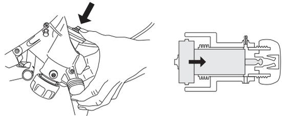
使用润滑脂润滑导辊套筒。把注油枪安到油嘴 (A) 上，并且注入润滑脂，直到溢出口 (B) 出现干净的润滑脂。
