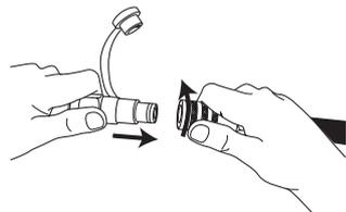
注意！ 在使用机器前，将接头上的安全钮旋到锁紧位置，确保软管不会突然松动。
