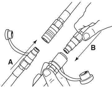
注意！ 如果软管长度超过 18m，可以将两条软管连接起来。不要连接两条以上的软管，因为接头会造成大量的功率损耗。参见《技术资料》篇。
