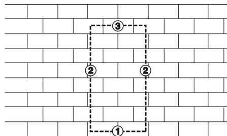
**注意！** 如果在下部水平切割之前进行上部水平切割，工件可能会掉落到锯片上并卡住锯片。
