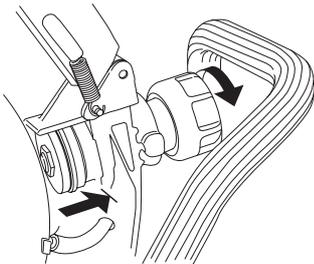
导辊压入旋钮。要松开导辊，你需要继续转动旋钮，直到完全松开。
