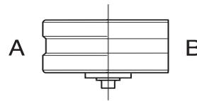
用新辊子替换磨损的辊子时，辊子和锯片必须进行对调整。
