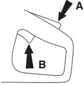
松开把手，使开关和开关锁复位。这是通过两个独立的复位弹簧系统来进行。这个位置使动力切割机停下来，开关被锁紧。
