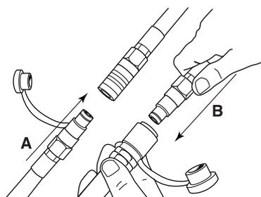
¡NOTA! Es posible conectar dos kits de manguera si se necesita una longitud de manguera de más de 18 m. No acoplar más de dos kits, puesto que los acoplamientos pueden causar una gran pérdida de efecto. Ver los 'Datos técnicos'.
