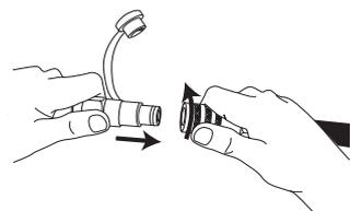
¡NOTA! Comprobar que las mangueras no se puedan soltar erróneamente, girando los bloqueadores de seguridad de los acoplamientos a la posición de bloqueo antes de usar la máquina.
