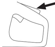
Controle que el acelerador y el bloqueador de acelerador se mueven con facilidad y que sus sistemas de muelles funcionan.
