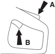
Cuando se suelta la empuñadura, el acelerador y el bloqueador de acelerador retornan a la posición inicial. Esto se hace con dos sistemas de muelles de retorno independientes. En esta posición la máquina se para y el acelerador es bloqueado.
