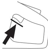
Presione el bloqueador de acelerador y controle que retorna a su posición inicial al soltarlo.
