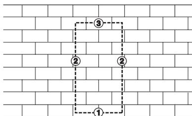
**¡NOTA!** Si el corte horizontal superior se hace antes del corte horizontal inferior, la pieza de trabajo cae sobre el disco y lo aprieta.
