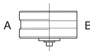
Cuando se sustituyen rodillos gastados por nuevos, hay que ajustar los rodillos contra el disco de corte. Ver las instrucciones bajo el titular 'Reglajes y ajustes'.
