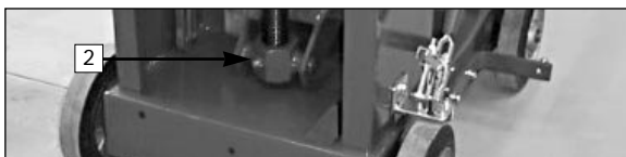
5.4.1-2 Point de lubrification de la vis de réglage en hauteur
