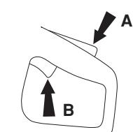
Όταν αφήσουμε ελεύθερη τη χειρολαβή, επανέρχονται και το γκάζι και η ασφάλεια γκαζιού. Αυτό ρυθμίζεται από δύο μεταξύ τους ανεξάρτητα συστήματα ελατηρίων επαναφοράς. Αυτή η θέση επιφέρει σταμάτημα του μηχανήματος και κλείδωμα του γκαζιού.
