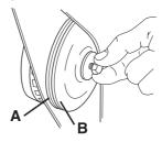
O eixo pode ser bloqueado com uma chave de fendas, perno metálico ou algo similar, encaixado o mais possível para dentro. O disco é apertado na direcção dos ponteiros do relógio.
