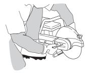
O parafuso de fixação do disco de corte deve ser apertado a 15-25 Nm.
