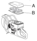
Retire o filtro de espuma de plástico. Lave minuciosamente o filtro numa solução de água morna e sabão. Após ter procedido à lavagem, enxagúe cuidadosamente o filtro com água limpa. Esprema depois o filtro e deixe-o secar. NOTA! Ar comprimido com demasiada pressão pode danificar o filtro de espuma.
