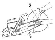
Coloque a protecção da correia e fixe a unidade de corte juntamente com a protecção da correia. Aperte os dois parafusos (4) manualmente.
