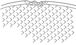
把研磨锯片挂在手指上，用螺丝起子等轻轻敲打进行测试。如果锯片没有发出清亮的共鸣声，则锯片定有破损。
