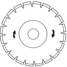
使用金刚石锯片时，确保按照锯片上箭头指示同一方向旋转。
