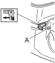
自动减压阀 机器配有自动减压阀, 这样会比较容易启动切割机。
