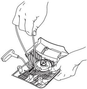
取掉启动器绳索的杂物, 并检查复位弹簧是否正常运行。通过启动器箱体和绳索滑轮中的孔插入新启动器绳索。
