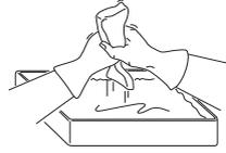
把滤清器放入塑胶袋并倒入滤清器油。揉捏塑胶袋以分配油量。把塑胶袋中滤清器剩余的燃油挤干, 装上滤清器之前倒空剩余的燃油。小心! 千万不可使用一般的发动机油。
