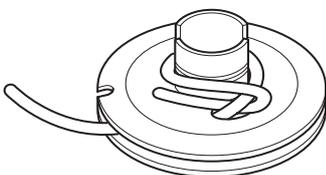
将绳索穿过滑轮边缘的开口, 并在滑轮中心上顺时针绕大约 3 圈。
