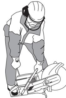
用右手抓住启动器, 慢慢地向外拉启动器绳索, 直到感觉到有阻力(止轮具抓紧), 然后快速用力的拉。
