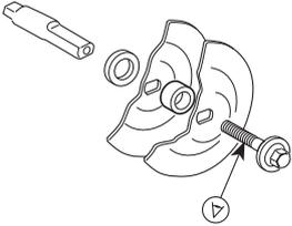
不要使用弯曲、有凹口、不整齐或肮脏的凸缘垫片。不要使用尺寸不对的凸缘垫片。
