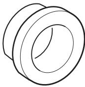
锯片是装在凸缘垫片 (A) 与凸缘垫片 (B) 之间的轴衬 (C) 上。上紧凸缘垫片以便装到轴上。
