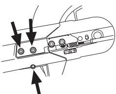
卸掉旧皮带, 换上新皮带。装上切割臂, 用调节器螺丝调整张力。运转大约30分钟后可以重新调整驱动皮带的张力。
