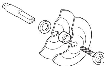
不要使用弯曲、有凹口、不整齐或肮脏的凸缘垫片。不要使用尺寸不对的凸缘垫片。
