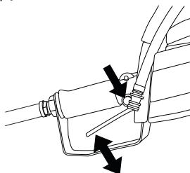
启动本机，松开电源开关，检查机器和切割锯片是否停止。
