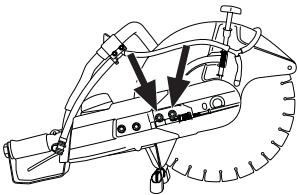
旋紧调节器螺丝, 使方头螺母正好对准罩子上的符号。如此, 皮带就自动具有正确的张力。
