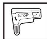
Stopp, mit Federrückgang zur Betriebsposition.
