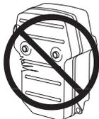
Regelmäßig kontrollieren, ob der Schalldämpfer fest am Gerät montiert ist.
