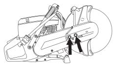
Dann die Stellschraube so drehen, dass sich die Vierkantmutter vor der Markierung am Gehäuse befindet. Der Riemen erhält so automatisch die korrekte Spannung.
