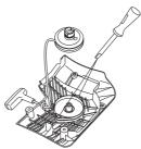
Startvorrichtung drehen, die Haken mithilfe eines Schraubenziehers lösen und die Rückzugfeder entfernen. Die Haken halten das Rückzugfederpaket an der Startvorrichtung.
