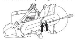
Dann die Bolzen herausschrauben und den Riemenschutz demontieren.
