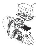
Um eine optimale Filterleistung zu erzielen, muss der Filter regelmäßig ausgetauscht oder gereinigt und eingeölt werden. Zu diesem Zweck wurde ein spezielles HUSQVARNA-Öl entwickelt.
