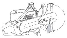
Wenn eine Diamantscheibe am Trennschleifer montiert wird, darauf achten, dass sie in der durch den Pfeil auf der Scheibe angezeigten Richtung rotiert.
