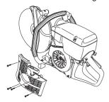
Das Seil etwa 30 cm herausziehen und in die Aussparung in der Außenkante der Seilrolle ziehen. Wenn das Seil intakt ist: Die Federspannung durch langsames Rückwärtsdrehen der Rolle lockern.
