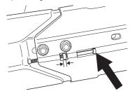
Die beiden Bolzen, die das Trennaggregat halten, mit dem Kombischlüssel anziehen.
