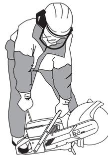
Agarre la empuñadura de arranque y tire despacio de la cuerda con la mano derecha, hasta sentir una resistencia (los dientes de arranque engranan), y después tire rápido y con fuerza.
