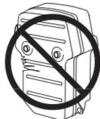
Regelmäßig kontrollieren, ob der Schalldämpfer fest am Gerät montiert ist.
