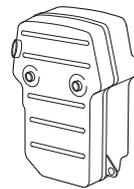
Das Gerät niemals benutzen, wenn sich der Schalldämpfer in schlechtem Zustand befindet.
