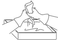
Filter in einen Plastikbeutel stecken und Filteröl hineingießen. Plastikbeutel zur Verteilung des Öls kneten. Filter im Plastikbeutel ausdrücken und überschüssiges Öl entsorgen, bevor der Filter montiert wird. Niemals normales Motoröl verwenden. Dieses Öl läuft ziemlich schnell durch den Filter und setzt sich am Boden ab.
