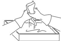
Nach der Reinigung ist der Schaumstofffilter einzuölen. Siehe die Anweisungen unter der Überschrift Einölen des Schaumstofffilters.
