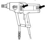
Motor in regelmäßigen Intervallen mit Druckluft reinigen. Inspektionsabdeckung entfernen und reinigen.
