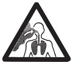
**ACHTUNG!** Bei Schleifarbeiten entsteht Schleifstaub. Das Einatmen des Staubs gefährdet die Gesundheit. Schleifarbeiten nur mit Atemmaske durchführen. Immer für ausreichend Belüftung sorgen.
