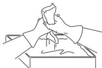
Introduzca el filtro en una bolsa de plástico y vierta el aceite para filtros. Masajee la bolsa para distribuir el aceite. Apriete el filtro en la bolsa y tire el exceso de aceite antes de colocar el filtro en la máquina. No use nunca aceite común para motores. Éste desciende bastante rápido a través del filtro, depositándose en el fondo.
