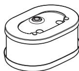
Un filtro utilizado durante mucho tiempo no puede limpiarse de todo. Por tanto, hay que cambiarlo a intervalos regulares. **Un filtro de aire averiado debe cambiarse.**
