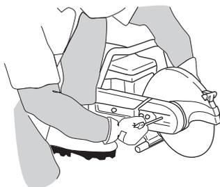
El tornillo que sostiene el disco de corte debe apretarse con un par de 15-25 Nm.
