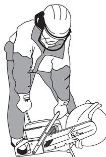
Agarre la empuñadura de arranque y tire despacio de la cuerda con la mano derecha, hasta sentir una resistencia (los dientes de arranque engranan), y después tire rápido y con fuerza.
