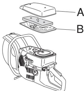
Saque el filtro de gomaespuma. Limpie bien el filtro en una solución de agua jabonosa tibia. Después de limpiar el filtro, enjuáguelo bien con agua limpia. Estruje el filtro y deje que se seque. ¡ATENCIÓN! El aire comprimido a una presión demasiado alta puede dañar el filtro de gomaespuma.
