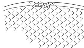
Pruebe el disco abrasivo colgándolo de un dedo y golpeándolo suavemente con el mango de un destornillador o similar. Si el disco no produce un sonido de tonalidad clara y limpia, es señal de que está dañado.
