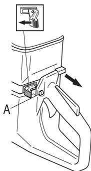
**Válvula de descompresión:** Presione la válvula hacia adentro para reducir la presión en el cilindro y facilitar así el arranque de la cortadora. Para arrancar se debe usar siempre la válvula de descompresión. Cuando la máquina ha arrancado, la válvula vuelve automáticamente a la posición de partida.
