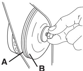
El eje se puede fijar con un destornillador, una varilla de acero o similar, que se introduce al máximo posible. El disco se aprieta girando a derechas.
