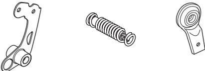
Compruebe que los elementos antivibraciones estén bien anclados entre la parte del motor y la parte de los mangos, respectivamente.
