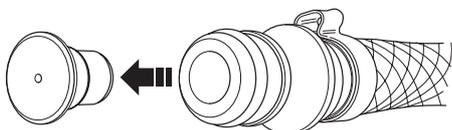
Cuando la presión de agua es baja (por ejemplo, al usar un depósito de agua), se puede desmontar la estrangulación para obtener el flujo de agua correcto.
