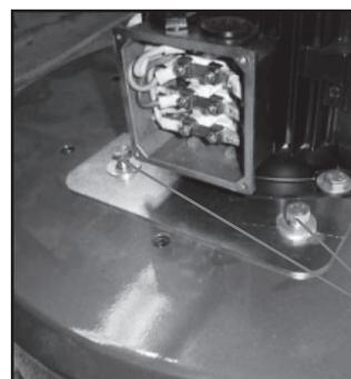
*Retire la cubierta de la caja terminal del motor.*
