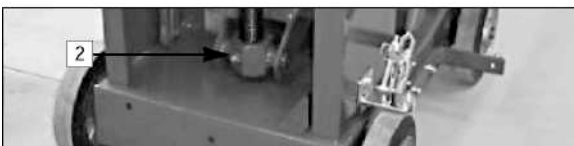
5.4.1-2 Puntos de lubricación del tornillo de ajuste de altura
