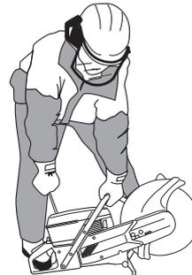
Saisir ensuite la poignée de démarrage de la main droite et tirer lentement sur le lanceur jusqu'à ce qu'une résistance se fasse sentir (les cliquets d'entraînement grippent), puis tirer énergiquement et rapidement sur le lanceur.
