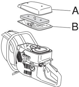
Retirer le filtre en mousse plastique. Nettoyer soigneusement le filtre dans de l'eau savonneuse tiède. Après le nettoyage, rincer soigneusement le filtre dans de l'eau propre. Essorer le filtre et le laisser sécher. **REMARQUE !** Un air comprimé présentant une pression trop élevée risque d'endommager le caoutchouc mousse.
