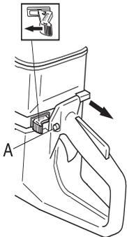
**Décompresseur:** Enfoncer le décompresseur pour réduire la pression dans le cylindre et faciliter le démarrage de la découpeuse. Toujours utiliser le décompresseur au démarrage. Une fois le moteur lancé, le décompresseur se remet automatiquement en position initiale.
