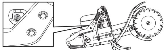
Régler la vitesse de ralenti à l'aide de la vis T. Si un réglage est nécessaire, commencer par tourner la vis de ralenti dans le sens des aiguilles d'une montre jusqu'à ce que les lames commencent à tourner. Tourner ensuite la vis dans le sens contraire des aiguilles d'une montre jusqu'à ce que les lames cessent de tourner. Lorsque le ralenti est réglé correctement, le moteur accélère sans hésitations.
