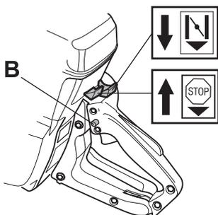
**Allumage:** Mettre le contacteur d'arrêt en position de démarrage.
