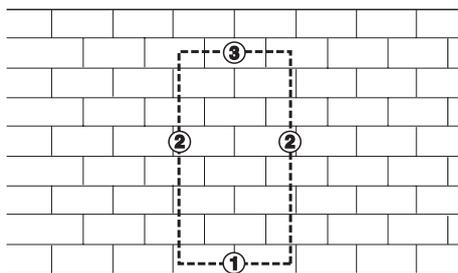
REMARQUE! Si l'entaille horizontale supérieure est réalisée avant l'entaille horizontale inférieure, la pièce de travail tombe sur les lames et les coince.
