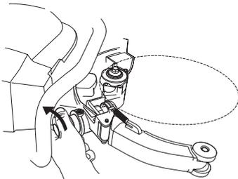
Le rouleau de guidage peut maintenant être retiré du châssis.
