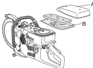
Pour un fonctionnement optimal du filtre, le remplacer ou nettoyer régulièrement et le huiler. Il existe une huile spéciale HUSQVARNA à cet effet.
