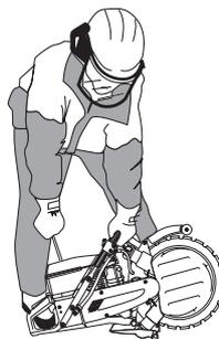
Saisir ensuite la poignée de démarrage de la main droite et tirer lentement sur le lanceur jusqu'à ce qu'une résistance se fasse sentir (les cliquets d'entraînement grippent), puis tirer énergiquement et rapidement sur le lanceur.
