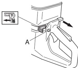
**Décompresseur:** Enfoncer le décompresseur pour réduire la pression dans le cylindre et faciliter le démarrage de la découpeuse. Toujours utiliser le décompresseur au démarrage. Une fois le moteur lancé, le décompresseur se remet automatiquement en position initiale.
