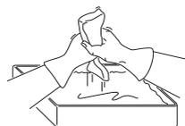
Après le nettoyage, le filtre en mousse plastique doit être huilé. Voir le chapitre Huilage du filtre en mousse plastique.
