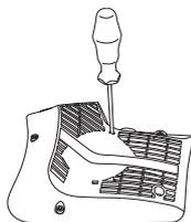
Penser que le ressort de rappel est tendu dans le corps du lanceur. Si le ressort s'échappe lors du montage, l'enrouler en commençant par l'extérieur et en continuant vers le centre.
