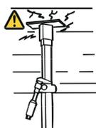
Contrôler que la fourche agrippe l'oeillet intérieur. Serrer avec une clé adéquate.
