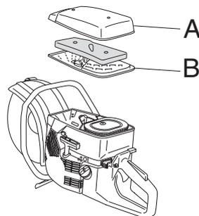
Rimuovere il filtro in materiale espanso. Pulire il filtro accuratamente con acqua saponata tiepida. Dopo la pulizia, risciacquare il filtro accuratamente con acqua pulita. Strizzare il filtro e lasciarlo asciugare. N.B! L'aria compressa usata a pressione troppo elevata può danneggiare il filtro in materiale espanso.
