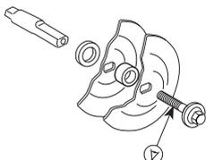
Non usare rondelle distorte, smussate, danneggiate o sporche. Non usare rondelle di diverse dimensioni.
