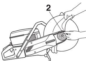
Montare la protezione della cinghia e fissare il gruppo di taglio alla protezione della cinghia. Serrare entrambi i bulloni (4) manualmente.
