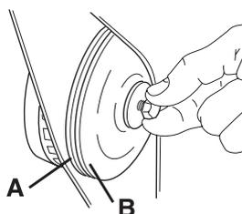
Per bloccare l'albero usare un cacciavite, una spina di acciaio o simili, spingerlo poi per quanto possibile. Serrare il disco in senso orario.
