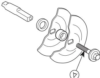
Не пользуйтесь фланцевыми шайбами с перекосом, со сбитыми краями, со следами ударов или грязными. Не пользуйтесь фланцевыми шайбами разных размеров.
