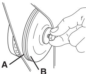
Ось можно открутить отверткой, стальным стержнем или другим подобным инструментом, который вставляется как можно дальше внутрь. Диск затягивается по часовой стрелке.
