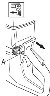
**Декомпрессионный клапан:** Прижмите клапан, чтобы понизить компрессию в цилиндре и чтобы облегчить запуск торцовочного станка. При запуске всегда пользуйтесь декомпрессионным клапаном. После запуска машины он автоматически вернется в свое первоначальное положение.
