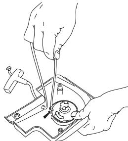
**ВНИМАНИЕ!** Проверьте, чтобы шкив стартера был повернут по крайней мере на половину оборота при полностью вытянутом шнуре стартера.
