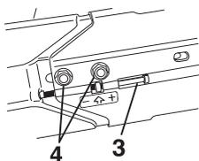
Ввинтите натягивающий винт (3) настолько, чтобы 4-х угольная гайка находилась напротив стрелки на щитке ремня. Потрясите узел, чтобы убедиться в том, что пружина может натягивать ремень. Это автоматически отрегулирует правильное натяжение на ремне. Затяните оба болта (4) комбинированным ключом. **ОБРАТИТЕ ВНИМАНИЕ!** При монтаже ремня, натяжение ремня должно быть затем опять отрегулировано, после того, как режущий станок использует два бака топлива.
