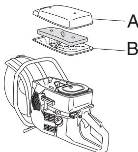
Снимите пенопластовый фильтр. Промойте тщательно фильтр в растворе теплой мыльной воды. После промывания тщательно прополощите фильтр в чистой воде. Выжмите и дайте фильтру просохнуть. **ОБРАТИТЕ ВНИМАНИЕ!** Сжатый воздух под высоким давлением может повредить пенопласт.
