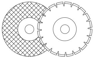
При транспортировке машины всегда снимайте режущий диск.
