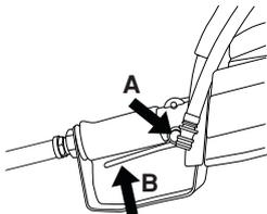
Фиксатор пускателя остается в прижатом внутрь положении до тех пор пока пускатель находится в прижатом внутрь положении. При отпускании ручки, пускатель и фиксатор пускателя возвращаются в свои исходные положения. Это осуществляется при помощи двух независимых одна от другой пружинных возвратных систем. В таком положении станок останавливается и пускатель замыкается.
