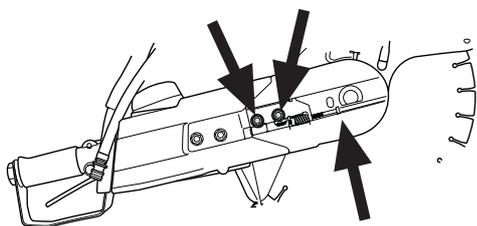
Открутите затем гайки и снимите передний колпак ремня.
