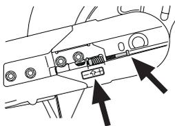
Затяните обе гайки, которыми закреплен режущий рычаг.
