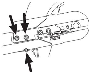
Снимите старый ремень и наденьте новый ремень. Смонтируйте вместе режущий рычаг с частью двигателя и натяните ремень регулировочным винтом. Новый приводной ремень должен быть затем опять подтянут через 30 минут работы.
