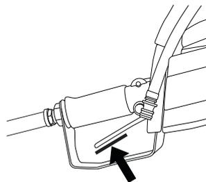
Прижмите внутрь фиксатор пускателя и проверьте, чтобы он возвратился в свое исходное положение когда он будет отпущен.
