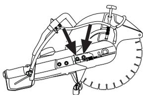
Навинтите затем регулировочный винт так, чтобы четырехгранная гайка находилась посередине отметки на колпаке. Натяжение ремня будет тогда автоматически правильным.
