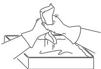
Τοποθετήστε το φίλτρο σε μια πλαστική σακούλα και περιχύστε το με το λάδι φίλτρου. Αναταράξτε ελαφρά την πλαστική σακούλα για να κατανεμηθεί το λάδι. Πλέστε ώστε να φύγει το παραπανίσιο λάδι από το φίλτρο και να συγκεντρωθεί μέσα στην πλαστική σακούλα και αδειάστε το περίσσευμα πριν τοποθετήσετε το φίλτρο στο μηχάνημα. Μη χρησιμοποιείτε ποτέ κοινό λάδι κινητήρα. Θα αποστραγγίζοταν μέσα από το φίλτρο αρκετά γρήγορα και θα συγκεντρωνόταν στη βάση του.
