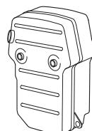
Μη χρησιμοποιείτε ποτέ μηχάνημα με ελαττωματικό σιγαστήρα.
