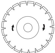
Χρησιμοποιείτε πάντοτε ακονισμένο διαμαντέ δίσκο. Ακονίστε τη λεπίδα πριονίζοντας σε μαλακό υλικό όπως αμμόπετρα ή τούβλο.
