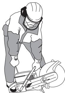
Πιάστε με το δεξί χέρι τη λαβή του μηχανισμού εκκίνησης, τραβήξτε αργά το κορδόνι μέχρι να βρείτε αντίσταση (να πιάσουν τα δοντάκια του μηχανισμού εκκίνησης) και μετά τραβήξτε γρήγορα και δυνατά το κορδόνι.
