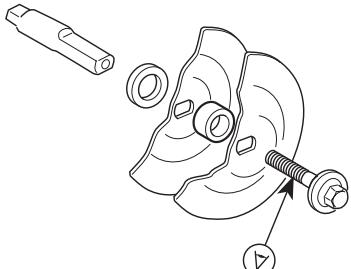
Μεν χρειασμοποιείτε στραβές, χτυπεμένες ή βρώμικες ψλάντζες. Μεν χρειασμοποιείτε ψλάντζες διαφορετικών διαστάσεων.
