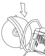
**ΠΡΟΕΙΔΟΠΟΙΗΣΗ!** Να ελέγχετε πάντοτε ότι ο προφυλακτήρας δίσκου είναι σωστά τοποθετημένος πριν βάλετε σε λειτουργία το μηχάνημα. Βεβαιωθείτε ότι ο δίσκος κοπής είναι τοποθετημένος σωστά και δεν εμφανίζει σημάδια ζημιάς. Ενας φθαρμένος δίσκος κοπής με ζημιά μπορεί να προκαλέσει τραυματισμό. Βλ. τις οδηγίες στο κεφάλαιο Συναρμολόγηση.
