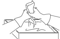
Τοποθετήστε το φίλτρο σε μια πλαστική σακούλα και περιχύστε το με το λάδι φίλτρου. Αναταράξτε ελαφρά την πλαστική σακούλα για να κατανεμηθεί το λάδι. Πιέστε ώστε να φύγει το παραπανίσιο λάδι από το φίλτρο και να συγκεντρωθεί μέσα στην πλαστική σακούλα και αδειάστε το περίσσευμα πριν τοποθετήσετε το φίλτρο στο μηχάνημα. ΠΡΟΣΟΧΗ! Μην χρησιμοποιείτε ποτέ συνηθισμένο λάδι κινητήρων.
