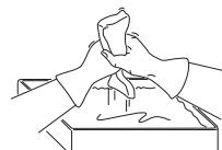
Τοποθετήστε το φίλτρο σε μια πλαστική σακούλα και περιχύστε το με το λάδι φίλτρου. Αναταράξτε ελαφρά την πλαστική σακούλα για να κατανεμηθεί το λάδι. Πιέστε ώστε να φύγει το παραπανίσιο λάδι από το φίλτρο και να συγκεντρωθεί μέσα στην πλαστική σακούλα και αδειάστε το περίσσευμα πριν τοποθετήσετε το φίλτρο στο μηχάνημα. Μη χρησιμοποιείτε ποτέ κοινό λάδι κινητήρα. Θα αποστραγγίζοταν μέσα από το φίλτρο αρκετά γρήγορα και θα συγκεντρωνόταν στη βάση του.
