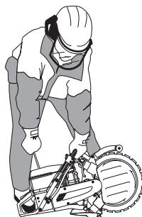
Πιάστε με το δεξί χέρι τη λαβή του μηχανισμού εκκίνησης, τραβήξτε αργά το κορδόνι μέχρι να βρείτε αντίσταση (να πιάσουν τα δοντάκια του μηχανισμού εκκίνησης) και μετά τραβήξτε γρήγορα και δυνατά το κορδόνι.
