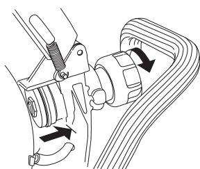
Ο κύλινδρος οδήγησης είναι τοποθετημένος μέσα στο πόμολο. Για να βγάλετε εντελώς το κύλινδρο οδήγησης στρίβετε ακόμη το πόμολο μέχρι να βγει εντελώς.
