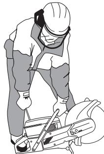
Πιάστε με το δεξί χέρι τη λαβή του μηχανισμού εκκίνησης, τραβήξτε αργά το κορδόνι μέχρι να βρείτε αντίσταση (να πιάσουν τα δοντάκια του μηχανισμού εκκίνησης) και μετά τραβήξτε γρήγορα και δυνατά το κορδόνι.
