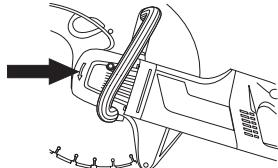
Όταν γίνεται αντικατάσταση του δίσκου κοπής να ελέγχετε τον στροφαλοφόρο άξονα και τις φλάντζες. Βλ. οδηγίες κάτω από την επικεφαλίδα Συναρμολόγηση δίσκου κοπής.
