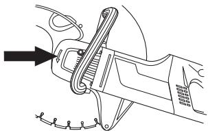
Χρησιμοποιείτε πάντοτε ακονισμένο διαμαντέ δίσκο.
