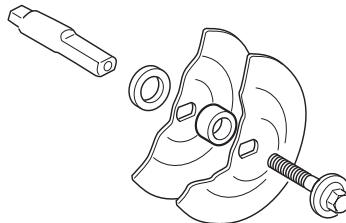
Μεν χρεσιμοποιείτε στραβές, χτυπεμένες ή βρώμικες φλάντζες. Μεν χρεσιμοποιείτε ψλάντζες διαφορετικών διαστάσεων.
