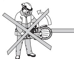
キックバックは、カッティングブレードのキックバックゾーンが対象物に触れた場合にのみ発生します。
