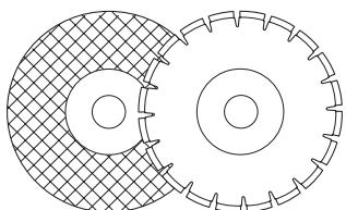
パワーカッターを運搬する時は常にカッティングブレードを外します。
