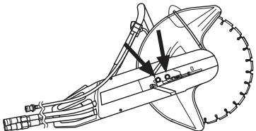
調整ねじを回して四角ナットがカバーのマークと反対側にくるようにします。こうするとベルトには自動的に適正な張りが与えられます。
