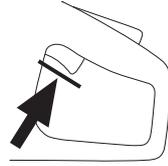
スイッチロックを押し、次に解放したとき、元の位置に戻るかを確認します。
