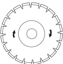
常に鋭利なダイヤモンドブレードを使用してください。砂岩やれんがなどの柔らかい材質の物に切り込むことでブレードを研いでください。
