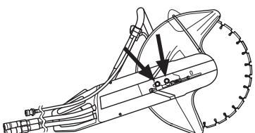
ナットを外し正面のベルトガードを持ち上げます。
