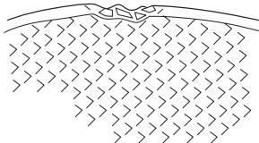
研磨ディスクを指にかけ、ねじ回しましたは同等な物を使用して軽く叩いてテストしてください。もしディスクが共鳴音を出さなければ、そのディスクは損傷しています。
