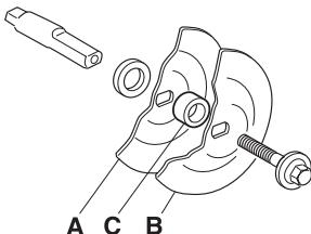
ブレードを固定するねじの締め付けトルク:15-25 Nm (130-215 in.lb)。
