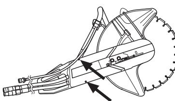
古いベルトを外し、新しいベルトに交換します。カッティングアームをパワーカッターに付け、調整ねじでベルトを調整します。新しいドライブベルトは30分ほど作動させた後、再度、張りの調整をしてください。
