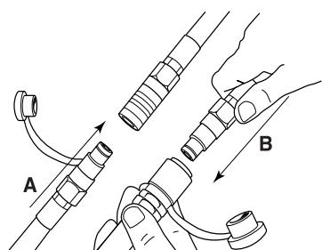
注意！ホースの長さが18 m以上必要な場合は、ホースキットを2個まで使用することができます。継手部分でのパワー損失が大きいため、キットは3個以上使用しないでください。詳細は主要諸元を参照してください。
