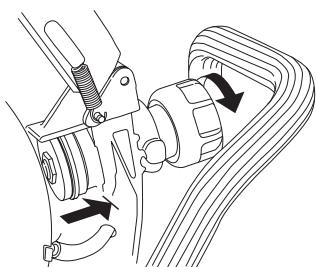
ガイドローラーをノブに押し込みます。ガイドローラーを取り外すには、ノブが外れるまでノブを回してください。
