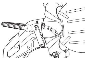
サポートローラーガードを固定している3本のネジを6mmの六角レンチで取り外し、カバーを取り外します。
