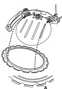
ガイドローラーがブレードの溝に入り込むよう、必要に応じてガイドローラーを押し込みます。
