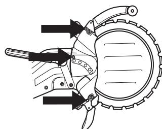
ブレードを回してみて、ブレードへのサポートローラーの当たりが強すぎないことを確認します。
