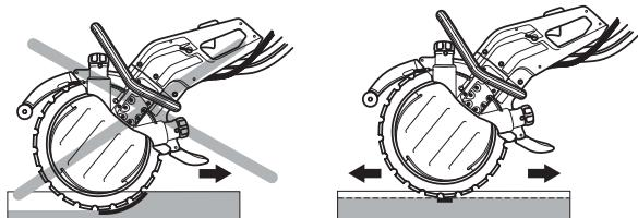
パワーカッター本体とブレードが一直線になるようにしてください。側面から圧力がかかるとブレード破損の原因となり、たいへん危険です。
