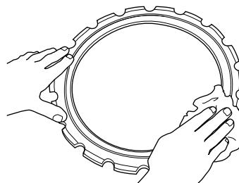
サポートローラーカバーのロックナットを取り外します。
