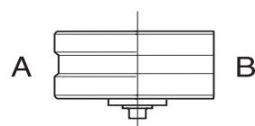
摩耗したローラーを交換したら、ブレードに対するローラーの当たり具合を調節してください。
