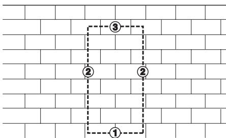
**注意！底辺を切る前に上辺を切ってしまうと、底辺を切っている途中で切削対象物が落下し、ブレードが挟まれてしまします。**
