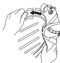
サポートローラーガードのロックナットを締め込みます。
