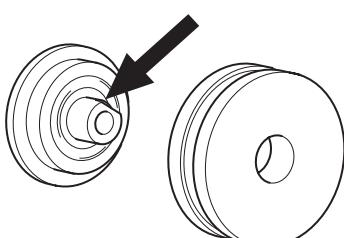
ローラーのフランジが約半分摩耗したら、ガイドローラーを交換してください。
