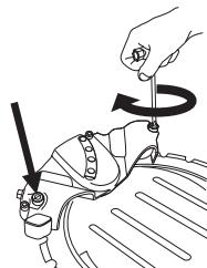
ブレードの回転中にサポートローラーを親指で軽く押さえると止められる程度に調節してください。サポートローラーは、ブレードの回転に伴ってときおり回転する程度で十分です。
