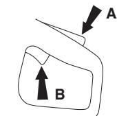
ハンドルから手を放すと、スイッチおよびスイッチロックともに元の位置に戻ります。この動きは、2つの独立したリターンスプリングシステムが制御しています。スイッチが元の位置に戻ると本機は停止し、スイッチがロックされます。
