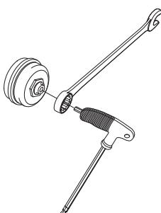
新しいローラーを取り付ける前に、ローラーの内側に軸受グリースを塗布します。
