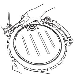
サポートローラーガードを取り付け、ガイドローラーのフランジがブレードの溝に正しく入っていることを確認します。3本のネジを締め込みます。
