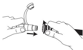
注意！本機を使用する前に継手のロックを回して固定し、予期に反してホースが外れることのないようにしてください。
