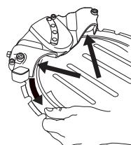
調節ネジでサポートローラーがブレードと接触するようにします。
