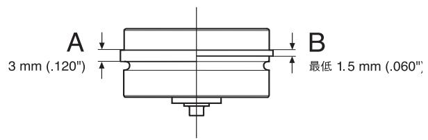
ローラーの表面が平らになったら、またはローラー表面の溝が摩耗したらサポートローラーを交換してください。
