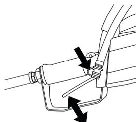
パワーカッターを始動し、スイッチを解放してからパワーカッターとブレードが停止することを点検します。
