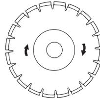
常に鋭利なダイヤモンドブレードを使用してください。砂岩やれんがのような柔らかい物質を切断してブレードの目立てを行ってください。
