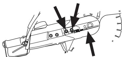
ナットを緩めてフロントベルトガードを外します。
