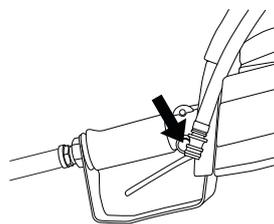
スイッチとスイッチロックが自由に動くことと戻りバネの機能を確認します。
