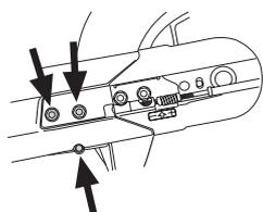
古いベルトを外して新しいものを取り付けます。カッティングアームをパワーカッターに取り付け、ネジを調整してベルトを張ります。新しいドライブベルトは、約30分稼働した後に再度張り直してください。
