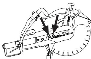
調節ネジを回し、角頭ナットがカバーの表記と反対側にくるようにします。これはベルトが自動的に正しい張力を持つようになるためです。
