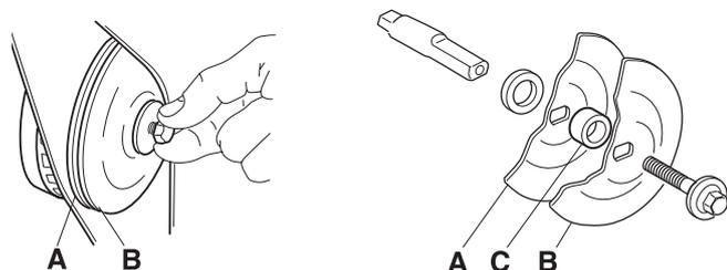
ブレードを固定するねじの締め付けトルク：15～25 Nm (130～215 in.lb)。
