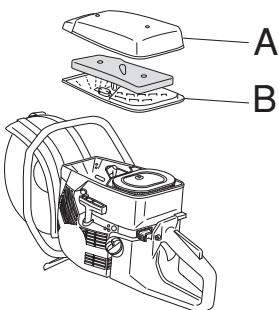
Noņemiet putuplasta filtru. Rūpīgi nomazgājet filtru remedenā ziepjūdeni. Pēc tīrīšanas noskalojiet filtru tīrā ūdeni. Izspiediet lieko mitrumu un laujiet filtram nožūt. IEVĒROJET! Saspiests gaiss ar pāraāk augstu spiedienu var sabojāt putuplastu.
