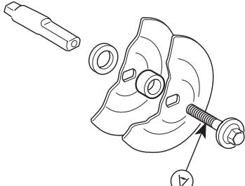
Nelietojiet deformētus, bojātus vai netīrus atlokus. Nelietojiet dažādu izmēru atlokus.
