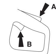
Drošinātājs paliek iespiests tik ilgi kamēr akselerators ir nospiests. Atlaižot rokturi, akselerators un akseleratora blokators atgriežas izejas pozīcijās. Tas notiek ar divu savstarpēji neatkarīgu atspēru sistēmu palīdzību. Šis stāvoklis garantē, ka akseleratora regulators automātiski brīvgaitā ir noslēgts.
