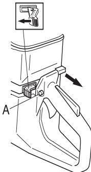
**Dekompresora vārsts:** Iespiediet vārstu, lai samazinātu spiedienu cilindrā, tādā veidā atvieglojot betona griešanas mašīnas iedarbināšanu. Iedarbināšanas laikā ir vienmēr jāizmanto dekompresijas vārsts. Kad mašīna ir iedarbināta, vārsts automātiski atgriežas izejas stāvoklī.
