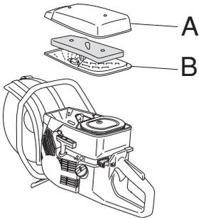
Fjern skumplastfilteret. Vask filteret grundig i lunkent såpevann. Etter rengjøring skylles filteret grundig i rent vann. Klem ut og la filteret tørke. OBS! Trykkluft under for høyt trykk kan skade skumplasten.
