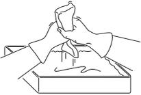
Legg filteret i en plastpose og hell på filteroljen. Kryst plastposen lett slik at oljen fordeles. Klem ut filteret i plastposen og hell ut overskuddsoljen før filteret monteres på maskinen. Bruk aldri vanlig motorolje. Denne synker ganske fort ned gjennom filteret og legger seg på bunnen.
