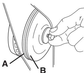
Akselen kan låses med skrutrekker, stålpinne eller liknende, som skyves inn så langt som mulig. Skiven trekkes til med urviseren.
