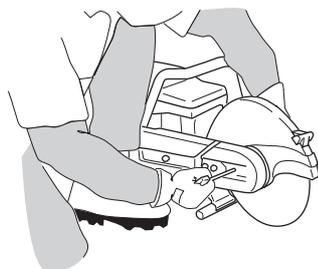
Skruen som holder kappskiven skal trekkes til med et moment på 15-25 Nm.
