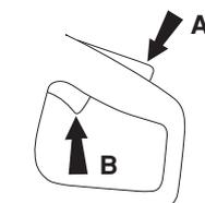
Sperren forblir inntrykt så lenge gassregulatoren er inntrykt. Når grepet rundt håndtaket slippes, tilbakestilles både gassregulatoren og sperren til sin opprinnelige posisjon. Dette skjer via to retur fjærsystemer som fungerer uavhengig av hverandre. Denne posisjonen innebærer at gassregulatoren automatisk låses på tomgang.
