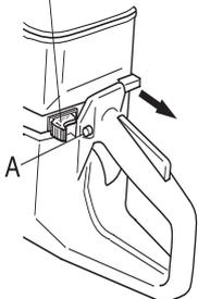
**Dekompresjonsventil:** Trykk inn ventilen for å redusere trykket i sylindren, slik at motorkapperen blir lettere å starte. Dekompresjonsventilen bør alltid brukes ved start. Når motorkapperen har startet går ventilen automatisk til utgangsstilling.
