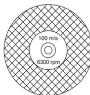
Kontroller at skiven er fri for sprekker og andre skader.
