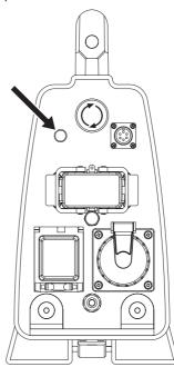
A válvula hidráulica na unidade de alimentação é agora fechada. A válvula abre novamente quando a rotação da lâmina é iniciada.
