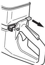
**Posição de acelerador de arranque - motor quente:** A configuração correta de estrangulador/acelerador de arranque é obtida puxando o controlo do estrangulador para a posição de estrangulador e depois empurrando-o de novo para dentro. Isto apenas engrena o acelerador de arranque sem estrangulação.
