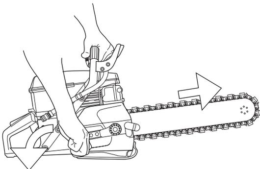
Segure na lâmina para cima pela extremidade e leve ao mesmo tempo a alavanca para cima/para a frente.
