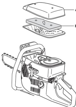
Retire o filtro de espuma de plástico. Lave minuciosamente o filtro numa solução de água morna e sabão. Após ter procedido à lavagem, enxágue cuidadosamente o filtro com água limpa. Esprema depois o filtro e deixe-o secar. NOTA! Ar comprimido com demasiada pressão pode danificar o filtro de espuma.
