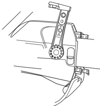
Vire a alavanca para a posição traseira inferior. Empurre a mola no punho tensor da corrente e gire manualmente a porca da lâmina no sentido dos ponteiros do relógio.
