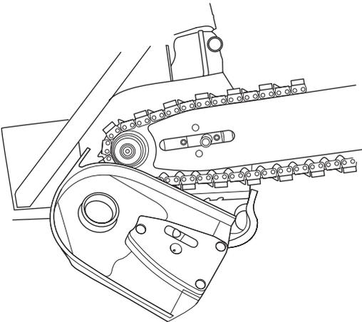
Retire a lâmina e a corrente.
