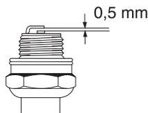
NOTA! Use sempre o tipo de vela de ignição recomendado! Uma vela de ignição incorrecta pode danificar o pistão/cilindro.
