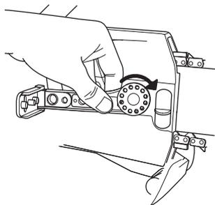
Solte a mola. Segure na lâmina para cima pela extremidade e leve ao mesmo tempo a alavanca para cima/para a frente. Note que o travão mecânico do braço não será atingido. O travão evita que o braço aponte para a frente e impede o corte.
