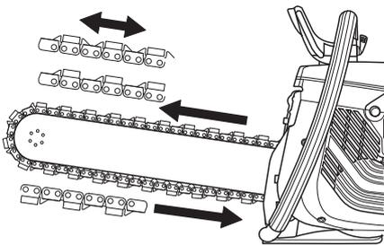
Quando utilizar uma corrente com limitadores de profundidade duplos, esta pode ser instalada nas duas direcções. Quando utilizar uma corrente com um limitador de profundidade, esta deve ser sempre instalada na direcção correcta. O limitador de profundidade deve guiar o segmento na altura certa durante o corte.
