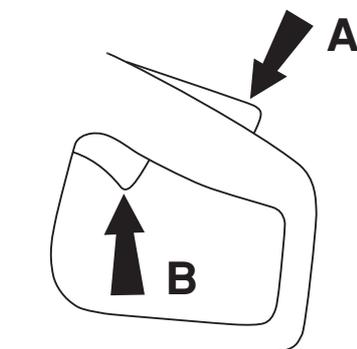
O bloqueio mantém-se apertado enquanto o acelerador estiver apertado. O acelerador e o bloqueio de acelerador retornam às suas posições originais quando se solta o punho. Isto ocorre por meio de dois sistemas de molas de retorno independentes entre si. Esta posição significa que o acelerador está sempre bloqueado na marcha em vazio.
