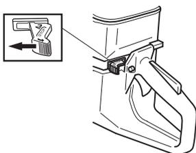
**Posição de acelerador de arranque - motor frio:** Posição de acelerador de arranque e estrangulador é obtida puxando o estrangulador completamente para fora.
