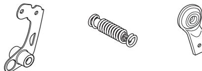
Kontrollieren, ob die Antivibrationselemente zwischen Motoreinheit und Handgriffeinheit fest verankert sind.
