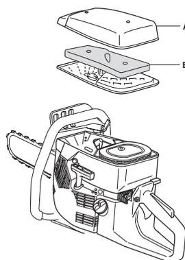
Retirer le filtre en mousse plastique. Nettoyer soigneusement le filtre dans de l'eau savonneuse tiède. Après le nettoyage, rincer soigneusement le filtre dans de l'eau propre. Essorer le filtre et le laisser sécher. **REMARQUE !** Un air comprimé présentant une pression trop élevée risque d'endommager le caoutchouc mousse.
