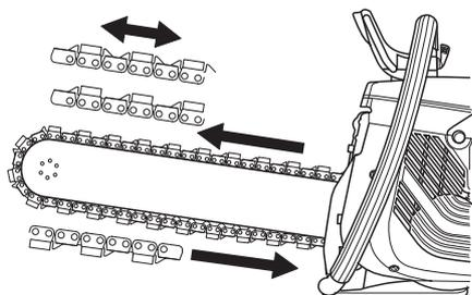
Quand on utilise une chaîne à racloir double, la chaîne peut être placée dans un sens comme dans l'autre. Quand on utilise une chaîne à racloir unique, il convient de toujours placer la chaîne dans le bon sens. Le racloir doit guider le segment à la bonne hauteur dans la découpe.
