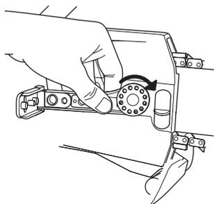
Relâcher le ressort. Lever le guide au niveau de son nez et pousser en même temps le levier vers le haut/l'avant. Attention : l'arrêt mécanique du bras ne peut être atteint. L'arrêt empêche le bras d'aller vers l'avant et évite les coupures.
