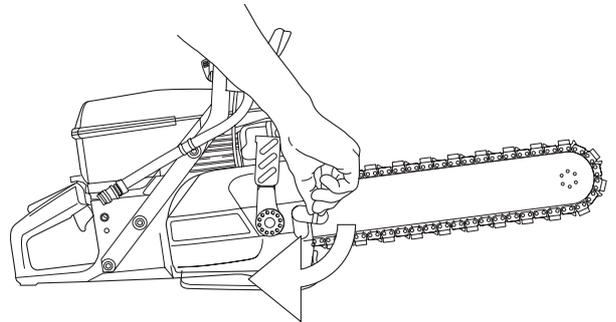
Une chaîne suffisamment serrée doit pouvoir être facilement guidée à la main.
