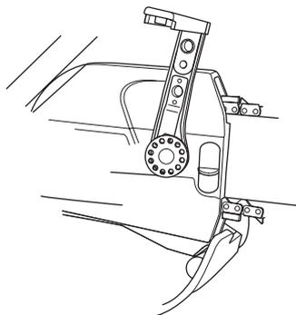
Pousser le levier sur sa position inférieure arrière. Enfoncer le ressort sur la poignée du tendeur de chaîne et tourner à la main l'écrou du guide-chaîne dans le sens des aiguilles d'une montre.
