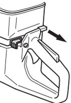
**Position ralenti accéléré - moteur chaud :** Pour procéder au réglage du starter/ralenti accéléré, il convient de tirer la commande du starter sur la position starter puis de la pousser de nouveau. Cela ne concerne que le réglage du ralenti accéléré, pas le starter.
