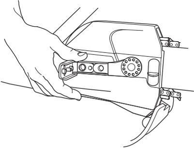
Enfoncer le ressort sur la poignée du tendeur de chaîne. Dévisser l'écrou de réglage du guide-chaîne dans le sens inverse des aiguilles d'une montre.
