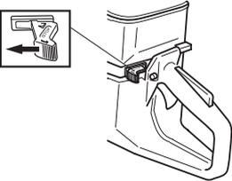
**Position ralenti accéléré - moteur froid :** Allumer la position ralenti. Pour le starter, il convient de tirer le starter complètement.
