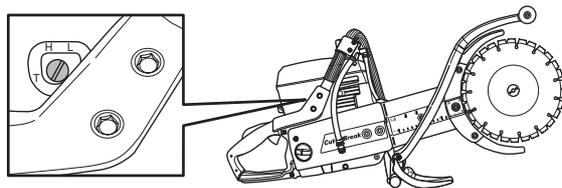
Régler la vitesse de ralenti à l'aide de la vis T. Si un réglage est nécessaire, commencer par tourner la vis de ralenti dans le sens des aiguilles d'une montre jusqu'à ce que les lames commencent à tourner. Tourner ensuite la vis dans le sens contraire des aiguilles d'une montre jusqu'à ce que les lames cessent de tourner. Lorsque le ralenti est réglé correctement, le moteur accélère sans hésitations.
