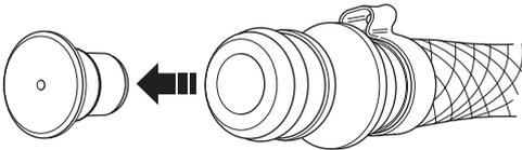
Si la pression d'eau est faible, par exemple lorsqu'un réservoir d'eau est utilisé, l'étranglement peut être démonté pour obtenir le débit d'eau correct.
