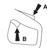
Le blocage reste enfoncé tant que la commande d'accélération est sollicitée. Lorsque la prise sur la poignée est relâchée, la commande d'accélération et le blocage de l'accélération reviennent en position initiale. Ceci s'effectue à l'aide de deux systèmes à ressorts de rappel indépendants l'un de l'autre. Cette position signifie que la commande d'accélération est alors automatiquement bloquée sur le ralenti et l'activation involontaire de cette commande est impossible.
