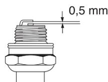
**REMARQUE!** Toujours utiliser le type de bougie recommandé! Une bougie incorrecte peut endommager le piston/le cylindre.
