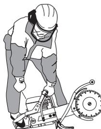
Saisir ensuite la poignée de démarrage de la main droite et tirer lentement sur le lanceur jusqu'à ce qu'une résistance se fasse sentir (les cliquets d'entraînement grippent), puis tirer énergiquement et rapidement sur le lanceur.
