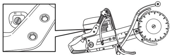
Regolare il minimo con la vite T. Se occorre effettuare la regolazione, girare innanzitutto la vite del minimo in senso orario finché le lame non iniziano a ruotare. Girare quindi la vite in senso antiorario finché le lame non smettono di ruotare. Il minimo è regolato correttamente quando il motore accelera in modo uniforme.
